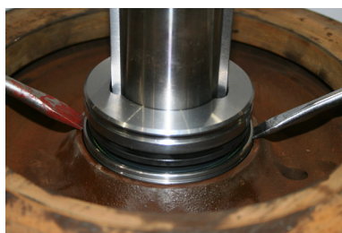
Рис. 14: Извлечение торцового уплотнения с помощью монтировок
